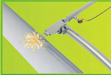
● 监控焊接冷却水
