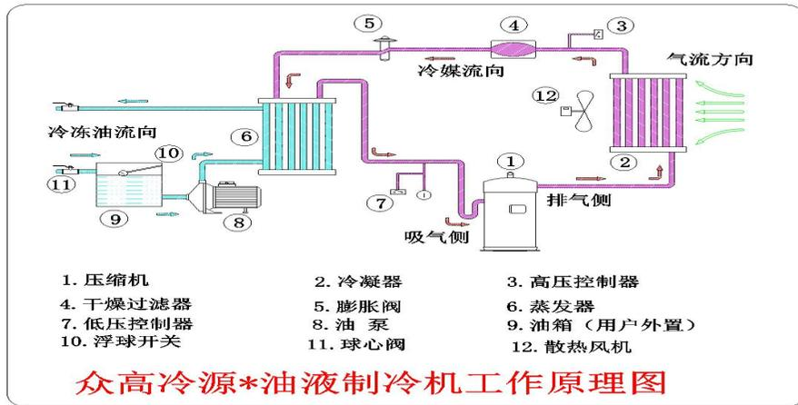
油液制冷机是利用压缩机降低并控制油液的温度。能够循环制造高低温、恒温、恒压、恒流的循环油液。油液制冷机包括四个主要组成部分压缩机、蒸发器、冷凝器、循环泵。不同压缩机可实现不同的制冷剂，以实现 75℃至-30℃不同的蒸发温度。
